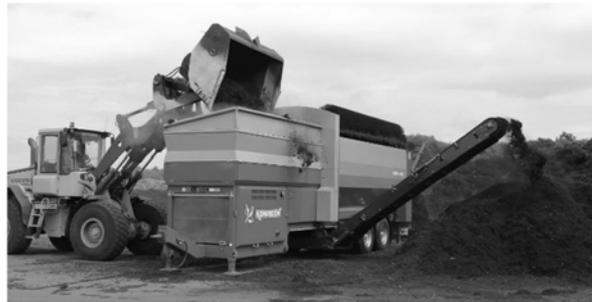
Abbildung 2: Abschließendes Sieben bei der Aufbereitung von Bodenaushub zur Komposterde
