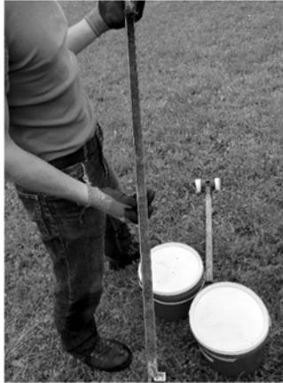
Abbildung 3: In-situ-Probenahme mittels eines Pürckhauer-Bohrstockes mit der Möglichkeit, den Boden in zwei unterschiedlichen Tiefen zu untersuchen.
