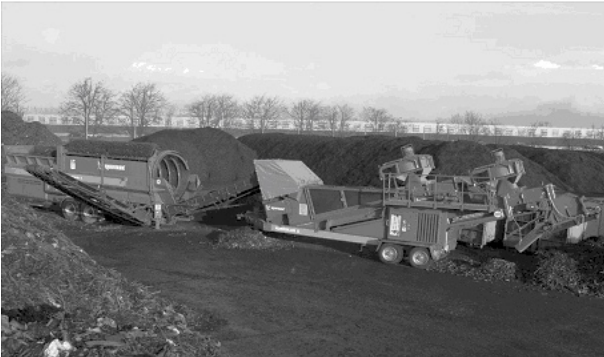
Abbildung 2 Störstoffentfernung durch Siebung (linke Maschine) des Kompostes am Ende der Rotte sowie Windsichtung (rechte Maschine), Magnetabscheidung (erster Haufen hinter der rechten Maschine) und Steinabscheidung (zweiter Haufen) des windgesichteten Überkorns (dritter Haufen)
