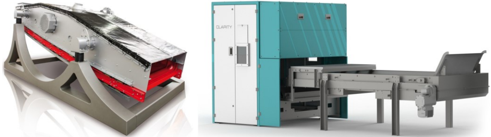
Abb. 3: Eingesetzte Maschinen: Spannwellen-Siebmaschine BIVITEC und sensorgestützter Sortierer auf VIS-Basis CLARITY
